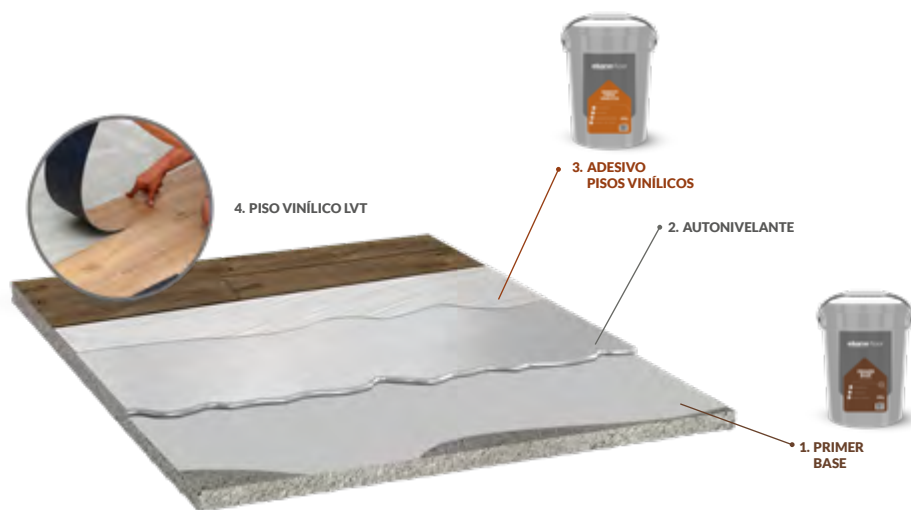
Figura 5. Etapas do processo de utilização dos insumos, contrapiso cimentício em pavimento superior
